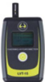
Messung von Lufttemperatur und relativer Luftfeuchtigkeit (RH).
