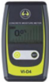
Für die Benutzung bei Feuchtigkeitsmessungen von Untergründen ausgelegt. Zerstörungsfreies Feuchtemessverfahren bei gleichzeitiger Aufrechterhaltung einer hohen Genauigkeit des Messergebnisses. Geeignet für die Vorprüfung der Belegreife von Baustoffen bei CM-Messungen.
